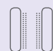
Bok L/P – bok ľavý alebo pravý Šírka 17 cm, hĺbka 96 cm, výška 55 cm
